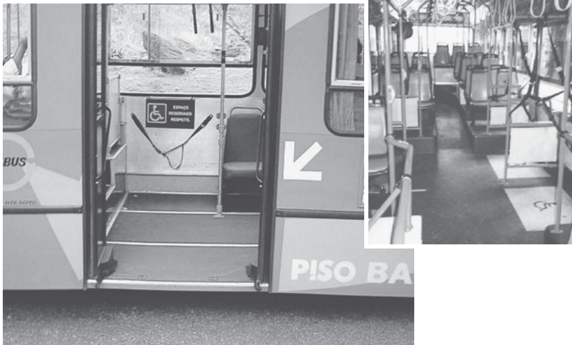
Fotos 28 y 29. Autobús de piso bajo. El de Belo Horizonte no tiene obstáculos internos y la diferencia de nivel para el acceso es sólo de 30 cm. El de Buenos Aires (a la derecha) no tiene desniveles internos y la última puerta tiene un escalón interno de 15 cm.
