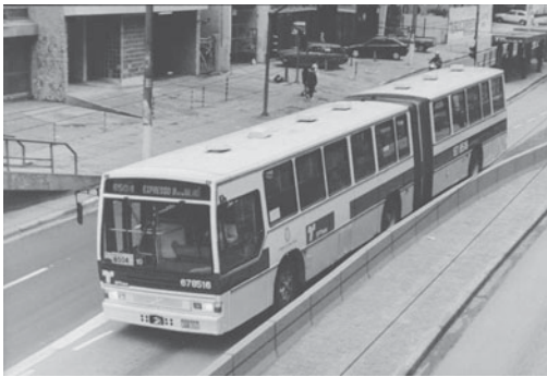
Foto 13. Autobús articulado saliendo de una parada en el carril exclusivo en São Paulo. En el corredor Itapeverica de la Serra, los autobuses hacen un desvío a la izquierda para tener acceso a las paradas en el sector central y después vuelven a circular a la derecha de ese carril.
