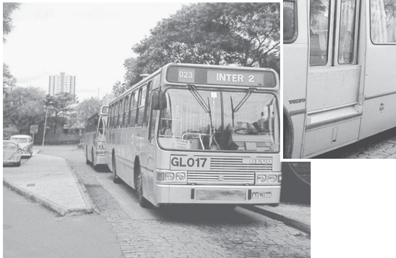
Fotos 8 y 9. El "ligeirinho" de Curitiba. Vista del autobús con puerta del lado izquierdo y detalle de la puerta con plataforma retráctil.
