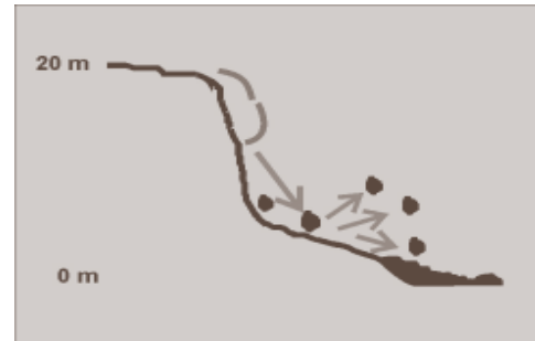
Figura 4. Esquema de un caído o derrumbe
