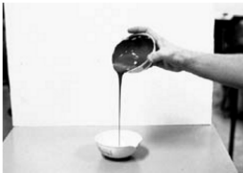
Figura 39. Las arcillas sensitivas pierden fácilmente su resistencia por alteraciones externas transformándose prácticamente en un líquido
