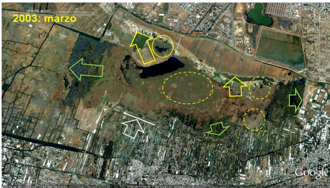
Figura 21. Escenario de las zonas sujetas a hundimiento e inundación en torno al lago en la primavera de 2003 destacando con flechas los efectos identificados en este estudio: avances previstos (verde); detención no prevista (blanco) y avance no previsto (amarillo). Los círculos permiten destacar la magnitud de la variabilidad del espejo de agua y de la distribución de la vegetación flotante.
