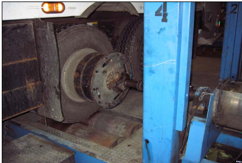
Figura 4.1 El adaptador de cubo del eje del vehículo a la unidad de absorción de potencia.
