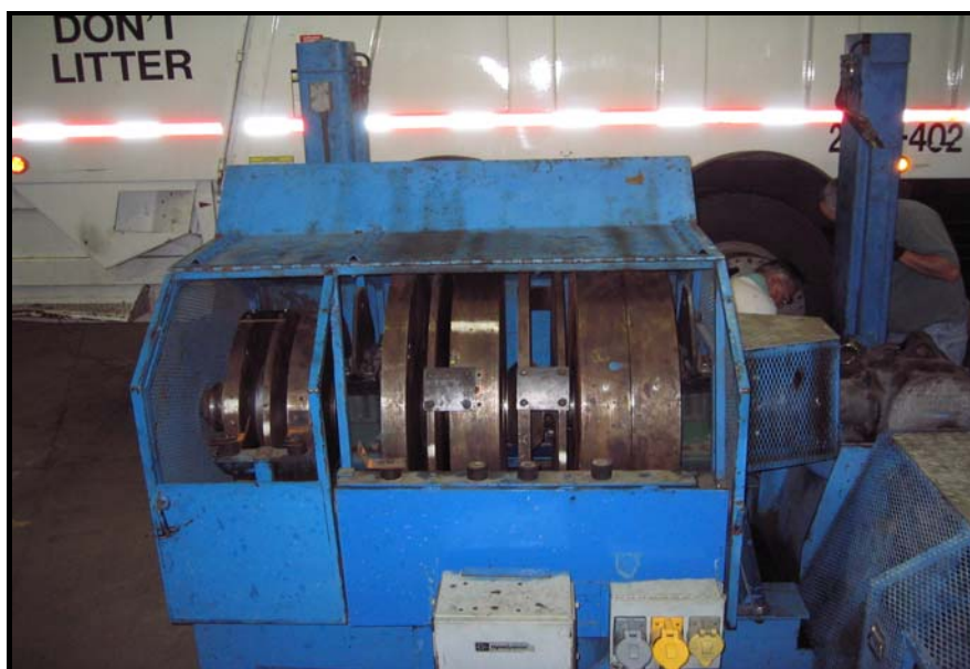
Figura 4.2 Las ruedas volantes se utilizaron para simular la inercia del vehículo.
