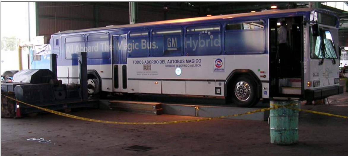
Figura 4.3 El laboratorio Móvil de la WVU probando el autobús híbrido-eléctrico ALLISON.
